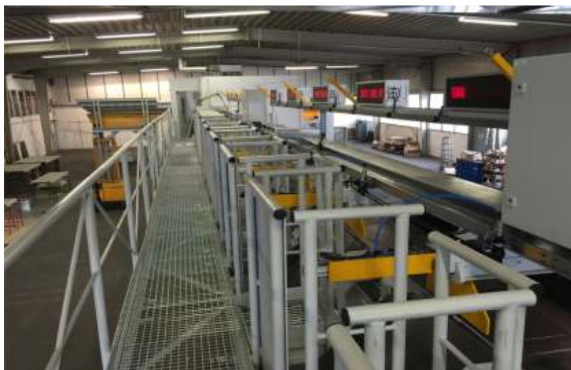
LIBS-Sortieranlage für Feuerfestmaterialien eines Partners
