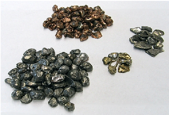
Bild 5 Typische Sortieranwendung im Recyclingbereich: Trennung von NE-Metallpellets.
