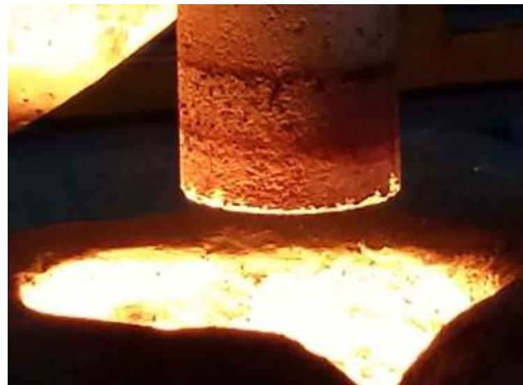
LIBS-Messung in einer Gusseisenschmelze
